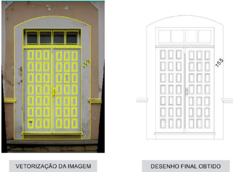
Figura 3 – Processo de vetorização e produto final obtido.
