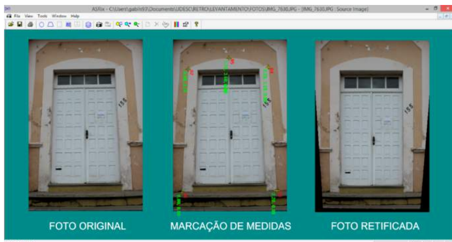
Figura 2– Processo de retificação no software ASRix 2.0 .
