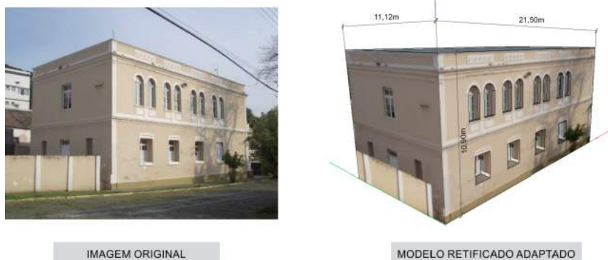
Figura 4 – Processo de retificação adaptada no software SketchUP 2015 .
